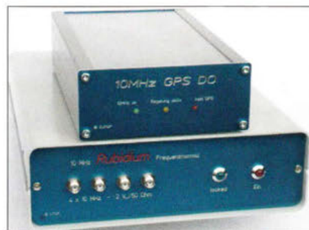
Bild 1: Selbst gebaute Referenzoszillatoren für das heimische Messlabor
