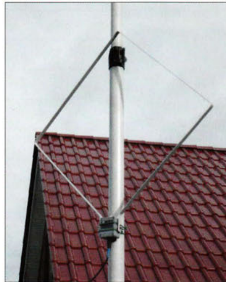
Bild 5: Für den Testbetrieb vorerst provisorische Montage der fest ausgerichteten kleinen Loop an einem Fiberglas-Teleskopmast
