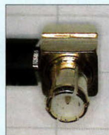
Bild 3: Der sog. MCX-Stecker ist in Funkamateurkreisen kaum verbreitet, ein Adapter oder Adapterkabel auf BNC ist daher zu empfehlen.
