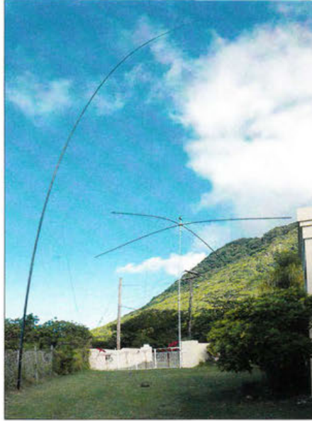
Ein Teil der Antennenfarm: links die 18 m hohe Vertikal für 80 m/160 m und rechts einer der Spiderbeams
