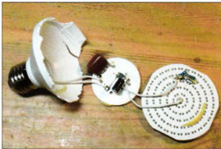
Bild 3: Blick in eine ausgefallene und danach zerlegte LED-Lampe Lunartec von 2005; Primitivschaltungstechnik ist verantwortlich für ein sehr kurzes Leben.
