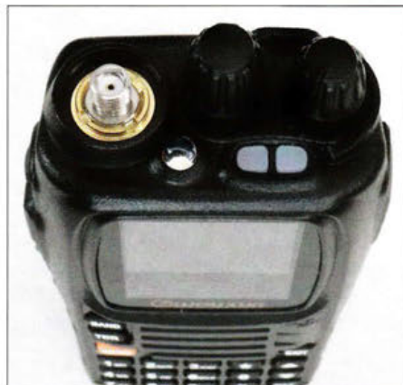
Bild 2: Dank der Standard-SMA-Buchse lassen sich andere moderne Antennen ohne Adapter anschließen.
