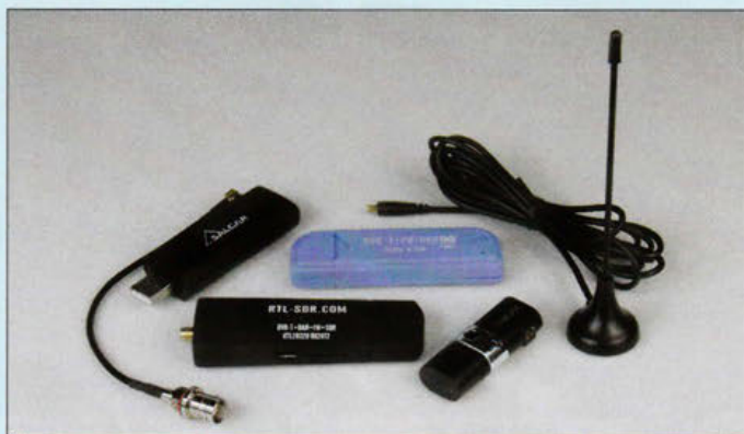
Bild 1: DVB-T-Sticks, v. l. n. r. Stick mit R820T-Tuner und optional erhältlichem Adapter auf BNC, der nur aus China zu beziehende Stick mit SMA-Anschluss und TCXO, in Blau ein Stick mit R820T2-Tuner sowie ein Stick der Marke Lenovo, der sich nicht als SDR eignet; daneben die mitgelieferte Antenne
