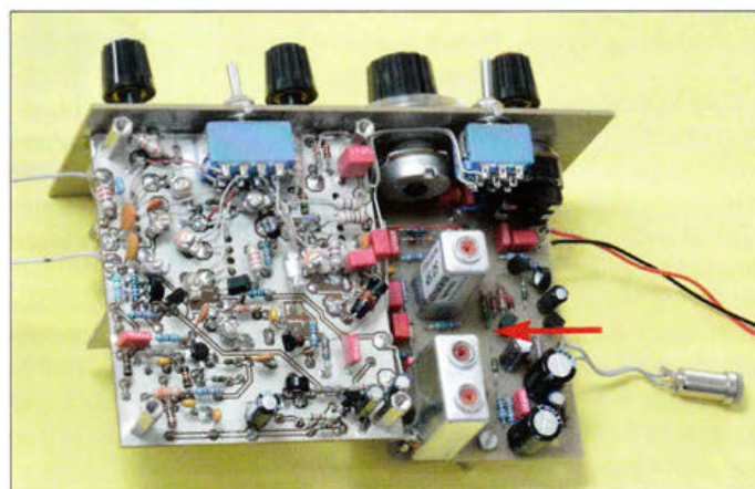
Bild 1: Komplett bestückte Hauptplatinen des selbst gebauten Nostalgie-Superhet-Empfängers; rechts die beiden Filterspulen des ZF-Verstärkers
