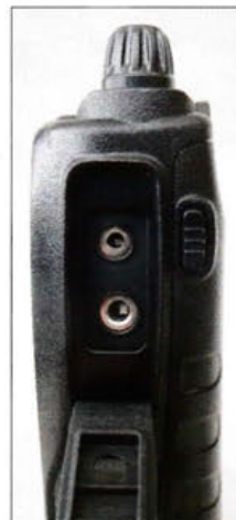
Bild 4: Eine Abdeckung schützt die obligatorischen Klinkenbuchsen.
