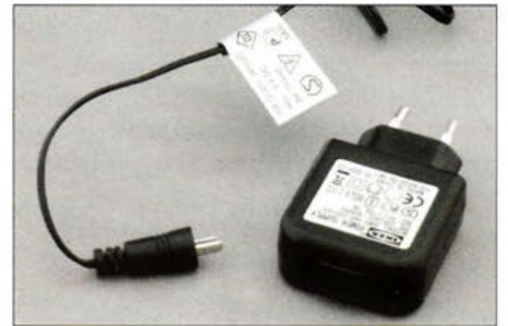
Bild 6: Netzteil einer LED-Leselampe von IKEA; es steht Tag und Nacht unter Spannung und nutzt einen hier etwas ungewöhnlichen Lautsprecherstecker als Verbindung.
