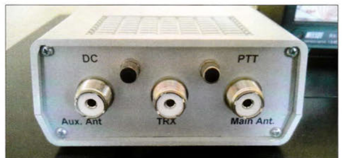
Bild 2: Antennenbuchsen auf der Rückseite für Hilfsantenne, Transceiver, Stationsantenne; oberhalb liegen Cinch-Buchsen für 12 V und PTT.
