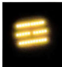
Bild 4: Blick auf den 3,6-W-Chip der AR 111
