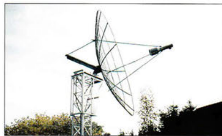
Der in Eigenbau realisierte 4,5-m-Spiegel von DJ9YW weist einen Gewinn von 33 dBi auf. Foto: DJ9YW
