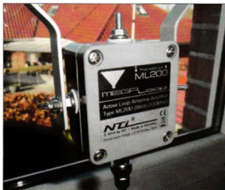
Bild 2: Aktiver Loop-Verstärker in einem robusten Kunststoffgehäuse mit massiven Anschlüssen
