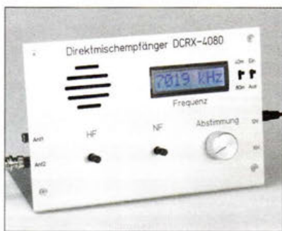
Musteraufbau des Direktmischempfängers DCRX 4080 für 40 m und 80 m
