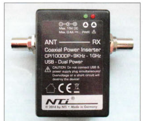
Bild 3: Fernspeiseweiche CPI1000DP zur Spannungsversorgung der ML200 über das Koaxialkabel
