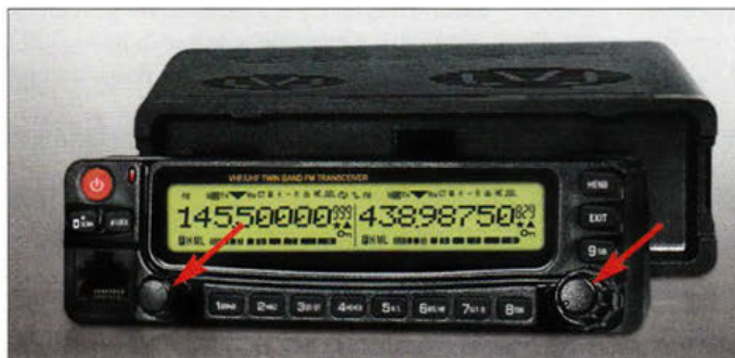
Das AMT-920-UV von Maas Elektronik weist die typischen Merkmale eines Twinbanders auf: Es werden zwei Bänder angezeigt und beide Bänder lassen sich simultan empfangen – u. a. zu erkennen an doppelt ausgeführten Lautstärke- und Squelch-Stellern. Werkfotos
