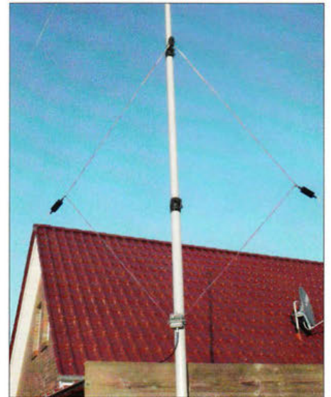
Bild 6: Die Großschleife aus 5 m Draht ist optimal für LW, MW sowie die unteren KW-Amateurfunkbänder 160 m und 80 m geeignet.
