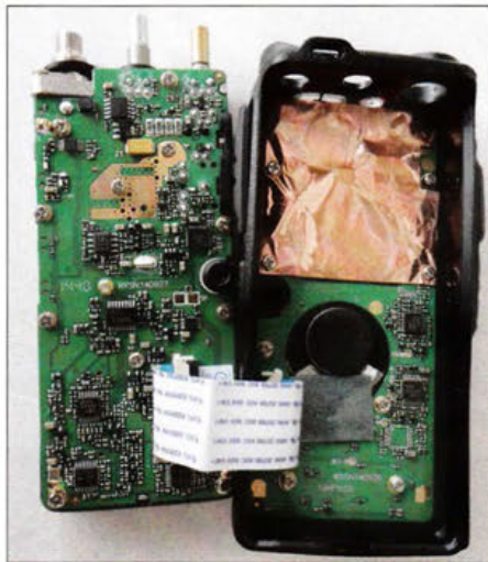
Bild 6: Eine Kupferfolie sorgt im Inneren für bessere Entkopplung.
