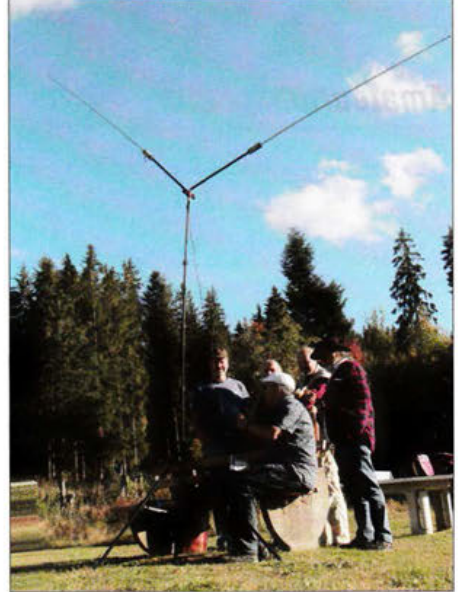
Teilnehmer des Schwarzwaldtreffens testen auf dem Schulgelände einen sogenannten Buddipol: eine Funkantenne für beengte Platzverhältnisse mit Verlängerungsspulen und beliebig ausziehbaren Teleskopstäben. Die Abstimmung ist allerdings nicht ganz einfach. Fotos: DK3JB
