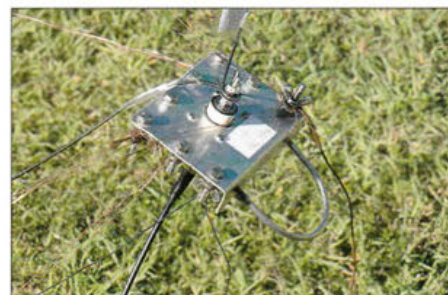
Selbst gebaut und sehr effektiv: die Einspeisung einer der Vertikalantennen
